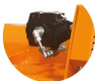
Moteur hydraulique à piston
