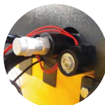
Commande d'inversion du sens de rotation des rouleaux en cabine
