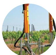
Contrôle hauteur tête extérieure par vérin hydraulique
